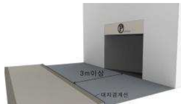
(지하주차장 출입구 이격)
