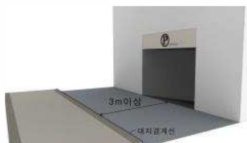
(지하주차장 출입구 이격)
